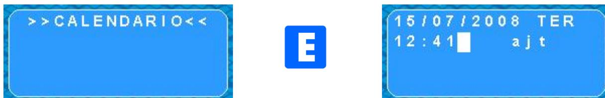
Para efetuar algum o ajuste no calendário, posicionar o cursor em **ajt** com a tecla (→) em seguida teclar (E) para entrar. Utilizar as teclas (↑) e (↓) para selecionar valores entre 0 e 9, com as teclas (←) e (→) desloca-se o cursor para as posições à esquerda e à direita, respectivamente. Definir os valores desejados em todos os campos e finalizar com a tecla (E).
