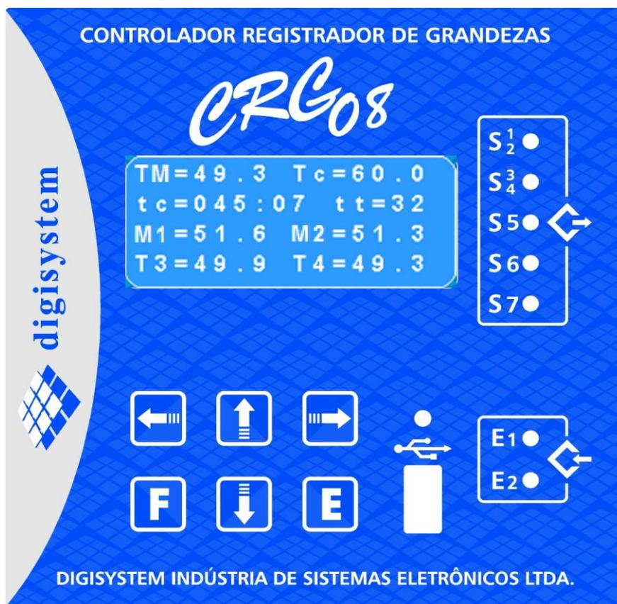
O led S6 se acenderá no início do processo do ciclo e se apagará quando atingir o tempo programado. O led S1 ficará aceso toda vez que o ambiente interno da câmara necessitar de aquecimento, ou seja, quando a temperatura do sensor selecionado (T2, T3, T4 ou a média dos três), Tcontrol em **SETUP**, ficar abaixo da temperatura de controle (Tc). Ao atingir essa temperatura, o led S1 se apagará. O led S7 acenderá somente na ocorrência de um alarme.
