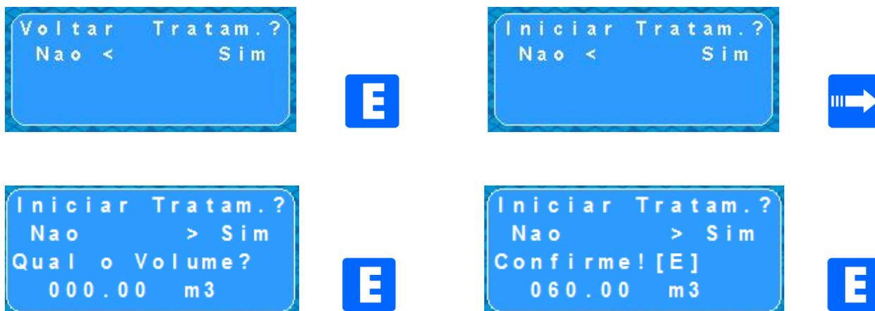
Para interromper o tratamento, quando estiver em execução, teclar (E) para entrar na função, em seguida teclar (→) para selecionar *Sim* e depois teclar (E).
