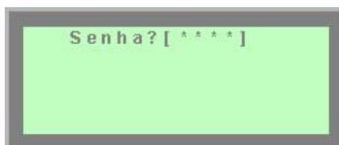
Para modificar a senha, por exemplo para "1111", colocar a chave cadeado no controlador, girá-la para a direita e desligar o controlador. Aguardar alguns segundos e ligar novamente, aparecerá no display do controlador a tela abaixo com o cursor piscando no primeiro zero (0).
