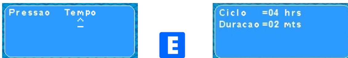
Na opção Tempo, é necessário adicionar Ciclo e Duração, adicionando valores em horas e minutos respectivamente. A função de cada parâmetro é a seguinte, Ciclo é o intervalo entre cada ação e a duração é o tempo da ação. Para finalizar usa-se a tecla (F) para retornar ao menu.
