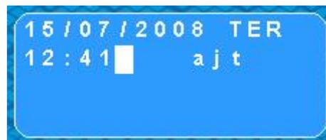
Para efetuar algum o ajuste no calendário, posicionar o cursor em **aj t** com a tecla (➡) em seguida teclar (E) para entrar. Utilizar as teclas (⬆) e (⬇) para selecionar valores entre 0 e 9, com as teclas (⬅) e (➡) desloca-se o cursor para as posições à esquerda e à direita, respectivamente. Definir os valores desejados em todos os campos e finalizar com a tecla (E).
